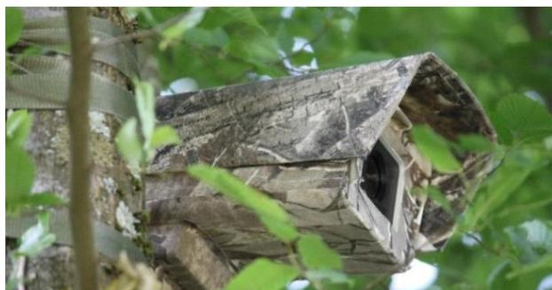
Abbildung 14: Wärmebildkamera Q 1941-E an einem Baum befestigt.
