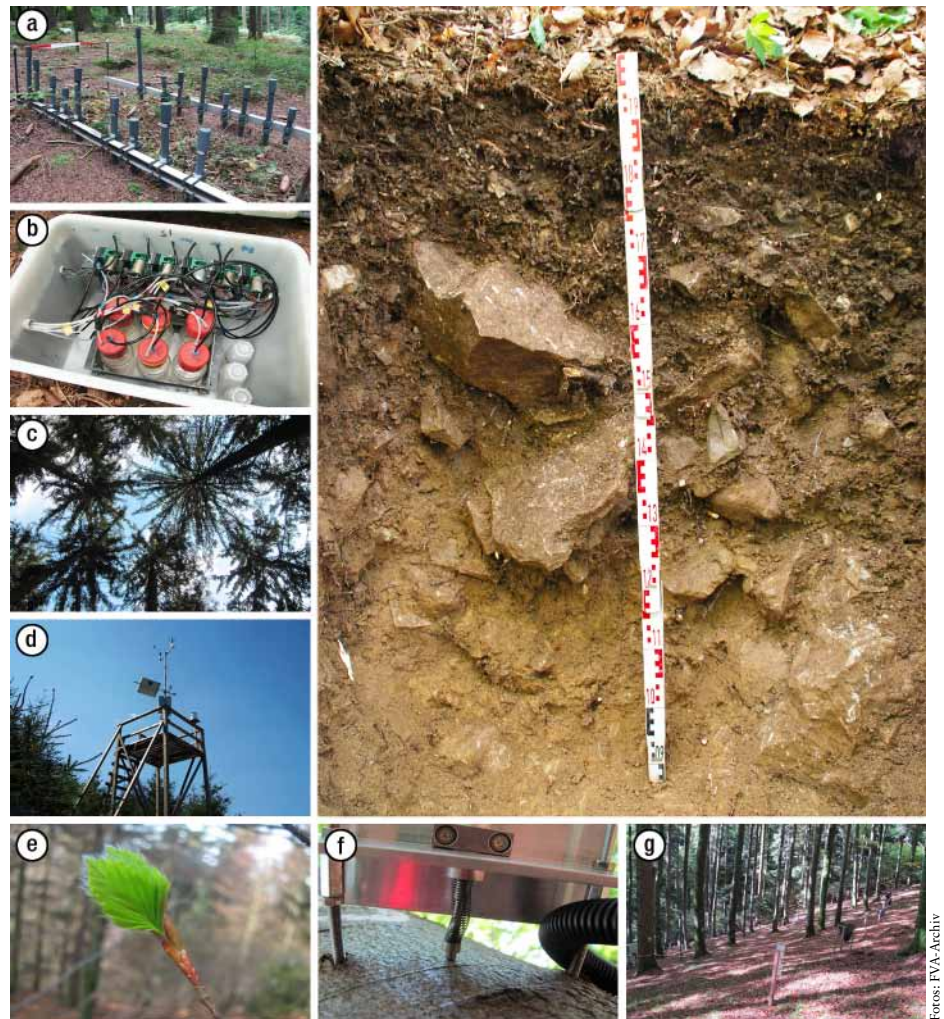
Abb. 2: Im Zentrum der Untersuchungen steht der Waldboden (oben rechts). Darüber hinaus werden auch weitere Proben und Parameter an den Messflächen der FVA aufgenommen: a) Bodengassammler; b) Gewinnung von Bodenwasser; c) Kronenzustand; d) Klimamesssturm; e) Phänologie; f) Dendrometer; g) Depositions- und Streufallsammler.
