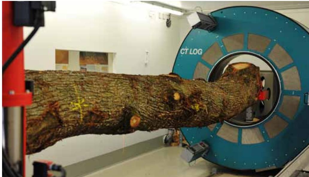
Abb. 1: Computertomograf CT.LOG an der FVA in Freiburg
